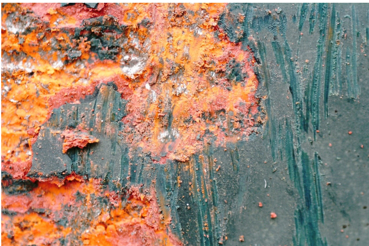
Pohled na barevné vrstvy vrat (na oceli dvě vrstvy miniového nátěru a nad ním stávající šedozelená s degradací na povrchu)
